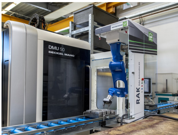
Robo Automation Kit im Einsatz an der Werkzeugmaschine mit 1x Robo Modul und 2 x Link Modul
