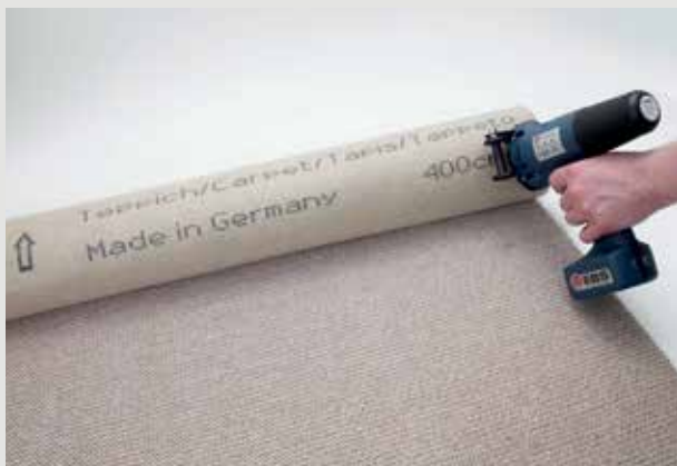
→ Druck auf Teppich/Fasermaterial mit schwarzer Universaltinte (Ethanol); 4-Rollen Führungsschiene.
