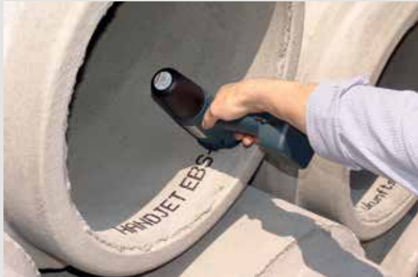
→ Druck auf Betonteile mit spezieller Betontinte für stärkere UV Resistenz; große Abstandsrollen.
