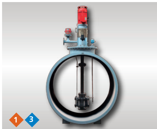
Verticale één- of meertraps staartpomp type NCT / HZV / NMT Met mechanische asafdichting of magneetkoppeling. Geschikt voor ATEX Zone 0.
