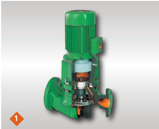
Verticale 'inline' centrifugaalpomp type NCV / KMV volgens EN- en ISO-normen Met mechanische asafdichting of magneetkoppeling.
