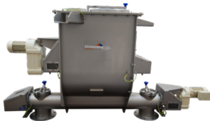
Hopper 1000 liter met doseerschroef. Doseerschroef links en rechts doserend
