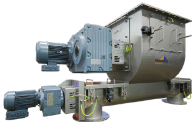
Woelbunker ingezet in een uitwendige Zone 22 en een inwendige Zone 20 (TUV gecertificeerd)
