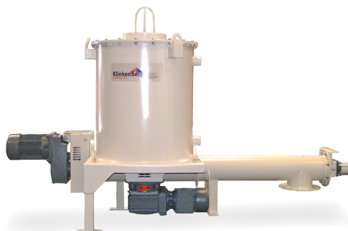
Agitatorunit met doseerschroef beladen door BigBag lossysteem
