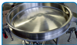
Delen in contact met het product van RVS AISI304
