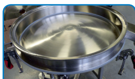
Delen in contact met het product van RVS AISI304
