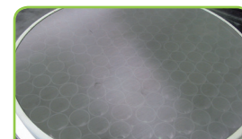
Système de décolmatage par anneaux plastique sous la toile
