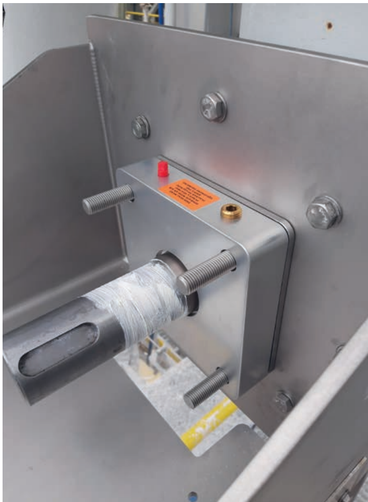
Afb. 2 De ingevette astap met de gemonteerde CinchSeal.
