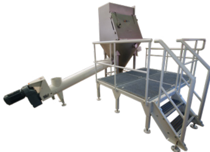
Zakkenstort met een geïntegreerde voedingsschroef, stofafzuiging en bordes.
