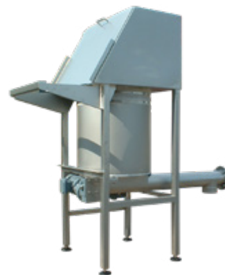
Zakkenstort met doseerschroef en agitatorbodem.
