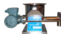
Volumetrisch doseerschroefje voor het doseren van granulaat, geplaatst op weegschaal.
