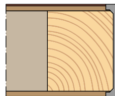
Zichtbare aangegoten kantlat - PU Kan enkel aangegoten worden in combinatie met een vlakke HPL (vanaf deurdikte 50)
