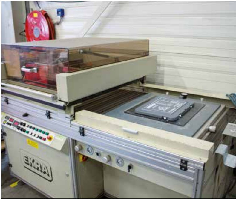
Machinaal zeefdrukken van deksels. Het deksel wordt machinaal onder de zeef gebracht en de inkt wordt automatisch gedrukt.
