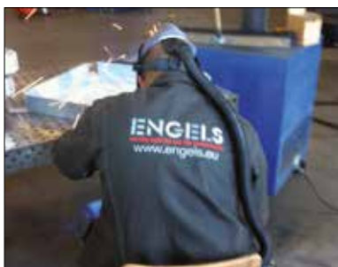
Lassen van aluminium. Veel van onze producten worden vanwege het lage gewicht en goede corrosieweerstand vervaardigd van aluminium.
