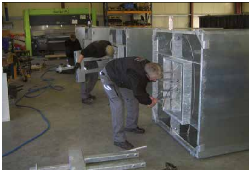
Assemblage van ondergrondse afvalcontainers.
