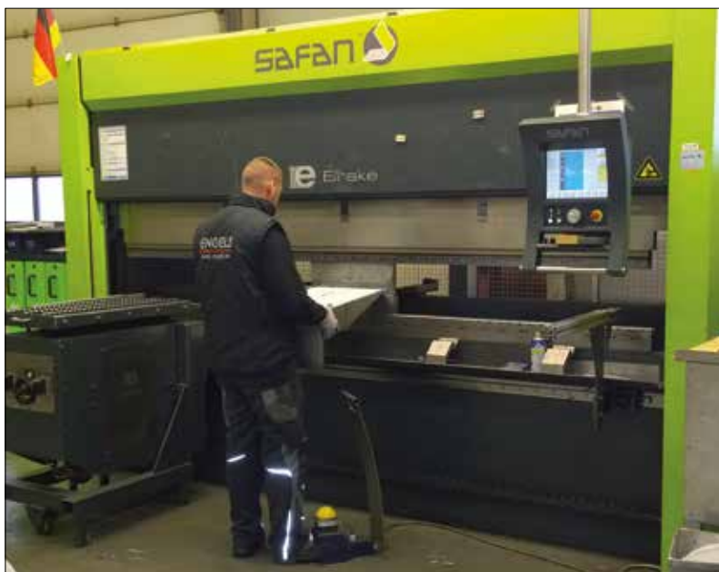
Onze moderne kantbank werkt met een CNC-besturing. Zelfs gecompliceerde kantwerkzaamheden in batch of massaproductie worden met een hoge precisie uitgevoerd.
