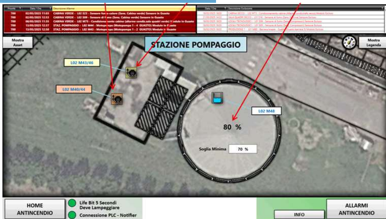
Figura 3 - Esempio supervisione realizzata – Schermata di ZONA
