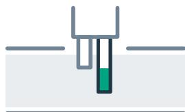
Si basa sul controllo del raffreddamento di un termoelemento "caldo" riferito ad uno "freddo". Si mantiene costante il deltaT modulando l'energia di riscaldamento, la quale sarà proporzionale alla portata di massa del fluido in transito. Questo principio a temperatura costante CT è indicato dalle ISO 14164 quale sistema comunemente più utilizzato a causa delle limitazioni dei termici che lavorano a corrente costante (CP).
