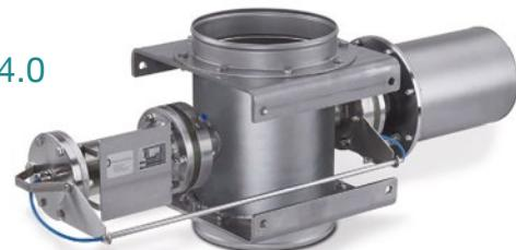
Il **DYNAsize** è un dispositivo di misura per la rilevazione in continuo della dimensione del particolato di materiali sfusi, compresi tra 170 e 6000 µm. Non è necessario prelevare campioni, poiché la misurazione avviene direttamente nel processo e in tempo reale.
