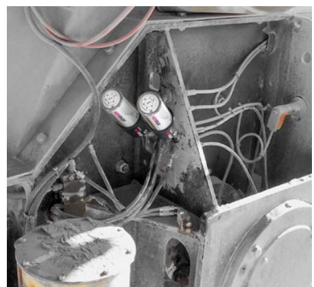
In una miniera, due potenziatori di pressione simalube IMPULSE connect compensano senza sforzo la contropressione di due cuscinetti. L'app simatec presenta inoltre i suddetti potenziatori nel piano di lubrificazione «Lubechart».
