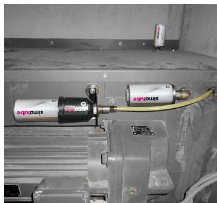
Il lubrificante viene fornito al punto di lubrificazione con lunghe linee di lubrificazione. Una staffa con due calamite fissano il simalube IMPULSE connect alla macchina.
