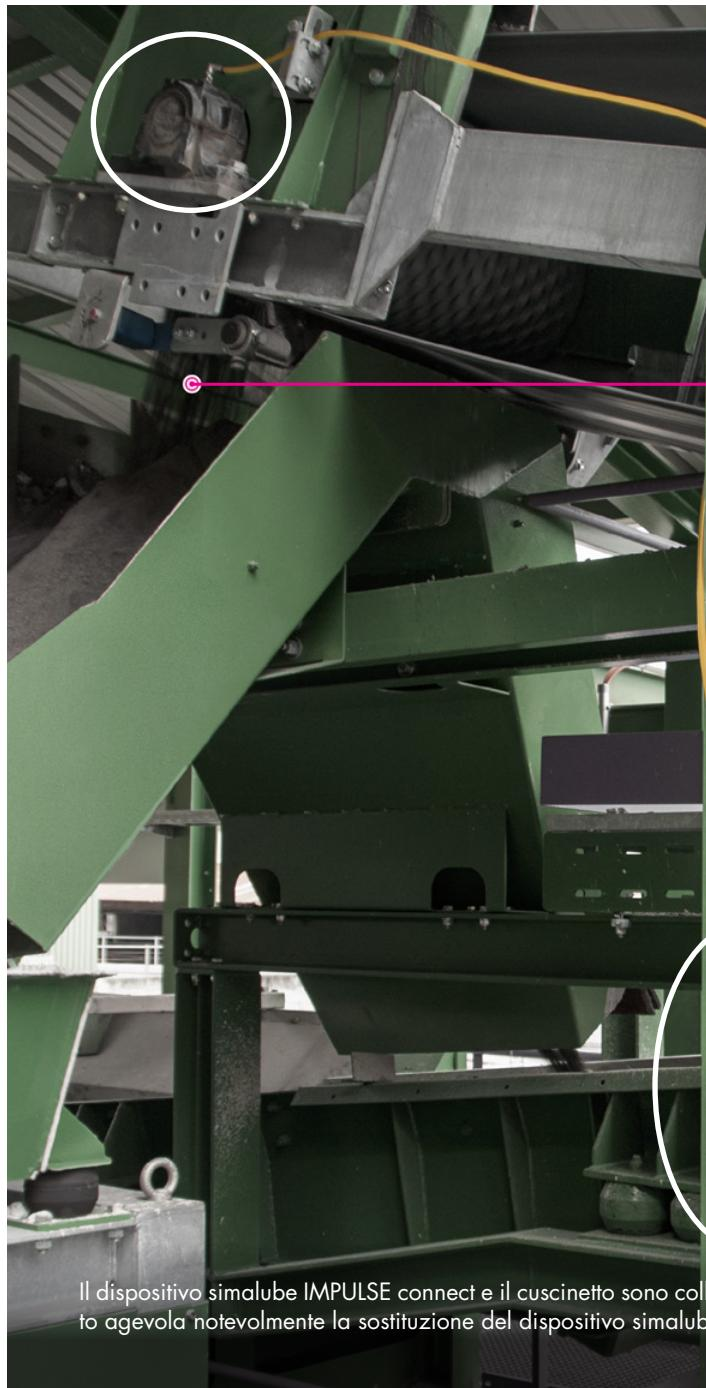
Il dispositivo simalube IMPULSE connect e il cuscinetto sono collegati da una lunga linea di lubrificazione. Questo agevolava notevolmente la sostituzione del dispositivo simalube.
