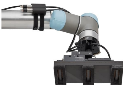
Aangepaste vacuümgrijper met in spuitstuk gemonteerde venturi vacuümpomp, .24 kg
