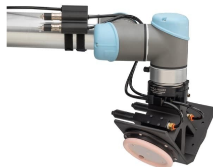
Tweekoppige vacuümgrijper voor het slijpen van flash uit gegoten siliconen onderdelen. Gewicht: .46 kg
