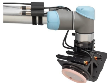
Pince à vide à deux têtes pour le broyage de l'éclair à partir de pièces en silicone moulé. Poids : 0,46 kg
