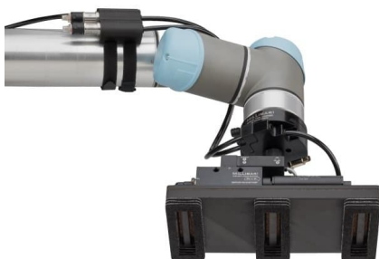
Pince à vide personnalisée avec pompe à vide venturi montée sur le collecteur, 0,24 kg
