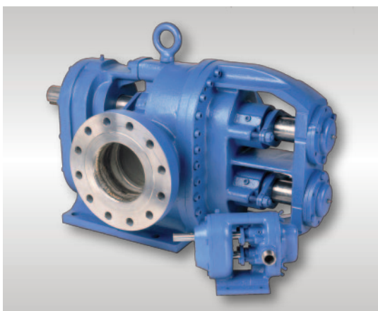
Roterende plunjerpompe (lobbe) type HD/ID Bij dit pomptype wordt er gebruik gemaakt van een externe tandwielkast, waardoor er geen metaal-metaalcontact bestaat tussen de roterende plunjers en zelfs droogloop mogelijk is. De pomp is verkrijgbaar met een enkelzijdige en dubbelzijdige lagerconstructie waarbij de dubbelzijdige lagerconstructie, bestand is tegen extreem hoge drukken. Tevens is dit type uitermate geschikt voor het verpompen van vloeistoffen waarin vaste delen voorkomen.
