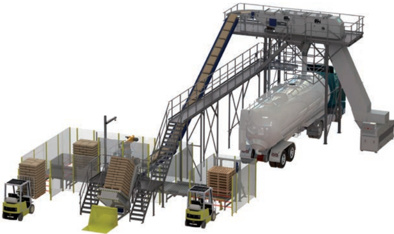
Volautomatische Galahad machine met multi-head robot en extra hef-/kantelbare tafel
