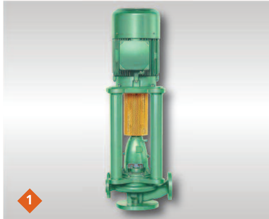
Verticale 'inline' centrifugaalpompe type NCVLR volgens API 610 Met mechanische asafdichting.
