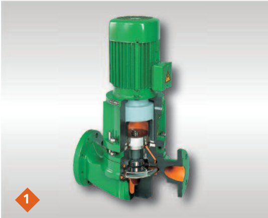
Verticale 'inline' centrifugaalpompe type NCV / KMV volgens EN- en ISO-normen Met mechanische asafdichting of magneetkoppeling.
