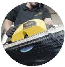
Ideaal voor het zagen van plaatwerk, roosters en sandwichpanelen tot 67 mm
