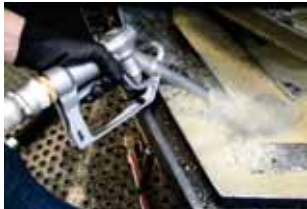
schnelle Entleerung der Flüssigkeit über Volumenstrom-Umkehrventil
