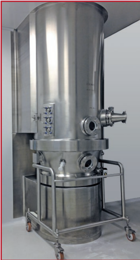
Lecho fluido a través de la pared Sécheur à lit d'air fluidisé à travers le mur
