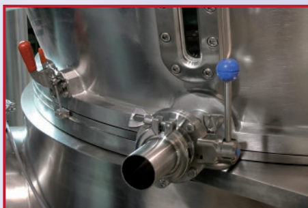
Descarga con transportador neumático Déchargement avec transport pneumatique
