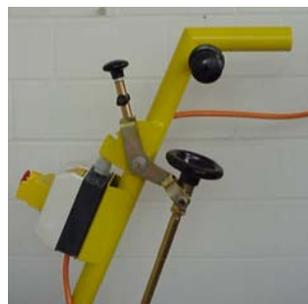
Die Stufenlose, fein regulierbare Einstellung der Arbeitstiefe sowie der Anpressdruck der Fräswerkzeuge. Dadurch wird die Oberfläche geschont.
