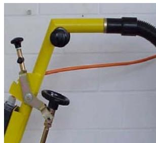
Staubfreier Einsatz durch integrierten Schlauchanschluss.
