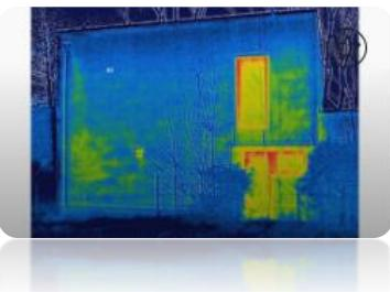
**Service de thermographie infrarouge** : une caméra thermique détecte avec précision les défauts invisibles d'un bâtiment (déperditions de chaleur, ponts thermiques, fuites d'air, défauts d'isolation), pour poser un diagnostic factuel et optimiser les futures consommations énergétiques.
