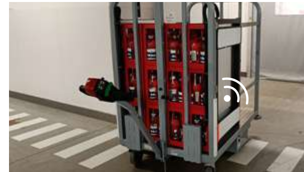
Beperkte mobiele RFID-apparatuur, geïntegreerd op bestaande logistieke karren
