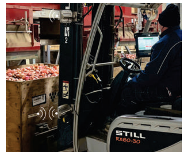
Geen manuele scanning van barcodes meer, maar automatische identificatie en lokalisatie via scanning van UHF-tags door RFID-leesapparatuur op heftrucks en vaste leespunten.
