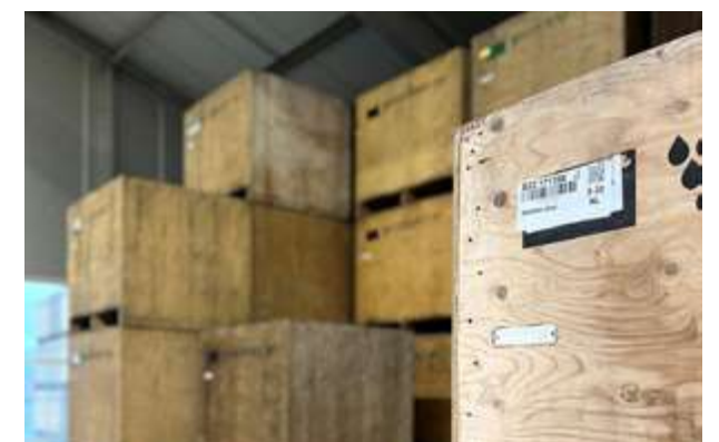
Lokalisatie van alle kisten gebeurt via het uitlezen van vloertags die in iedere rij van de stockruimte worden ingeslepen. De heftrucks capteren de magazijnlocatie als ze er overheen rijden.
