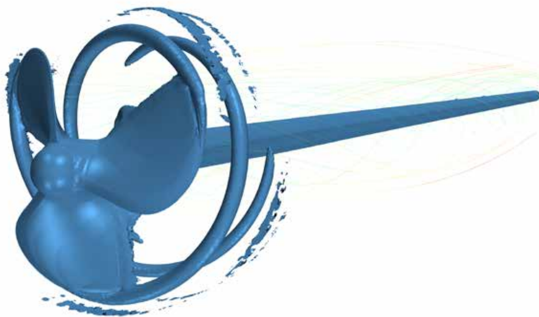
Uit een eerste CFD-scan (computational fluid dynamics) van de schroef met scheve rand kwam een vermogenstoename van 2,3 procent.
