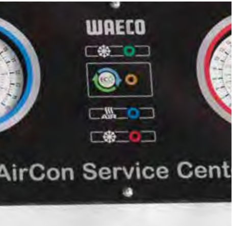
Volledige terugwinning van koudemiddel, inclusief de resterende hoeveelheid in de gebruikte olie
