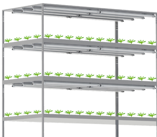
Meerlaagse teeltopstelling vegetatieve groei 8 lampen per groeilaa in 4 lijnopstellingen voor gereduceerde bekabeling PPFD 435 µmol/sm 2
