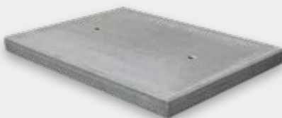
BETONPLAAT 20 TON 150 x 200 x 16 cm Enkele wapening - Vellingkant
