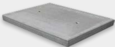
BETONPLAAT 20 TON 150 x 200 x 14 cm Enkele wapening - Vellingkant
