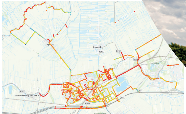
Meting op netwerkniveau. Meerdere wegen inmeten, integreren in het beheersysteem.
