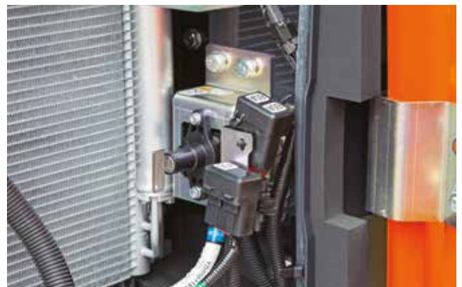
De massaschakelaar zorgt ervoor dat onderhoud veilig kan worden uitgevoerd.
