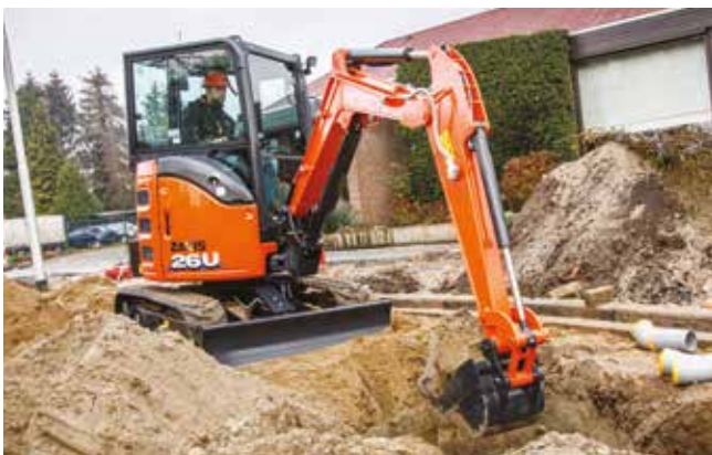
De boomcilinder is voorzien van een beschermplaat, voor extra duurzaamheid.
