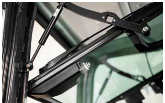
De gasgeveerde voorruit is soepel en gemakkelijk te openen.
