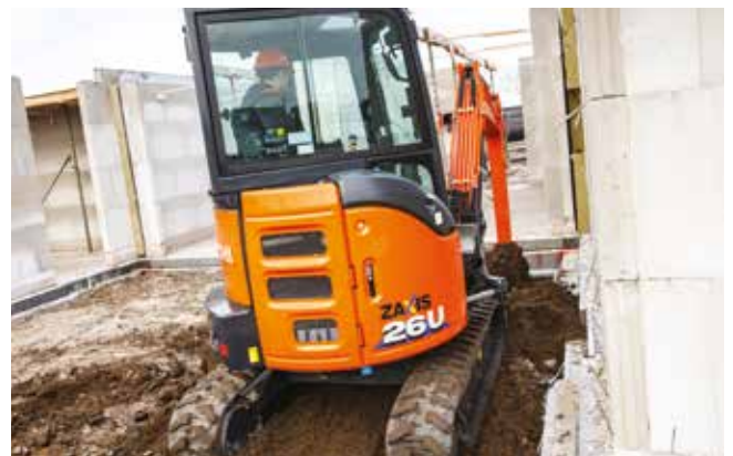
De korte draaicirkel is ideaal voor gebruik in smalle ruimten.
