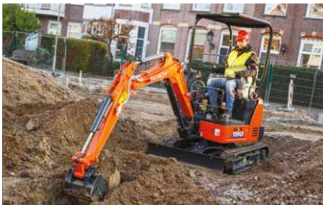
De uitschuifbare rupsen verhogen de veelzijdigheid en stabiliteit.
