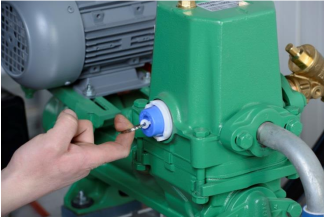
Griffing am Druckstopp zur Funktionsüberwachung
