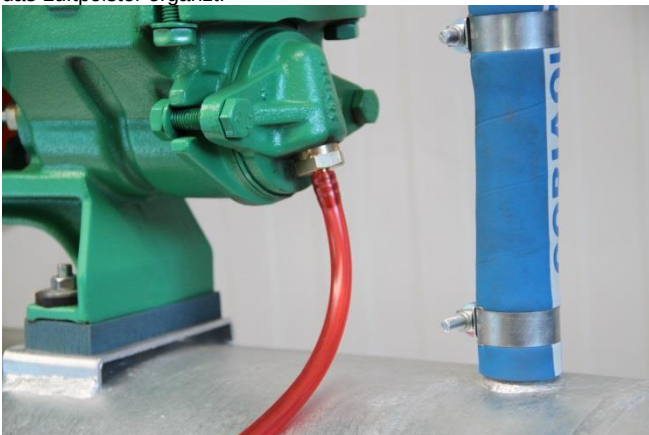
Spezial-Schnüffelventil mit Luftwartschlauch (rot)
