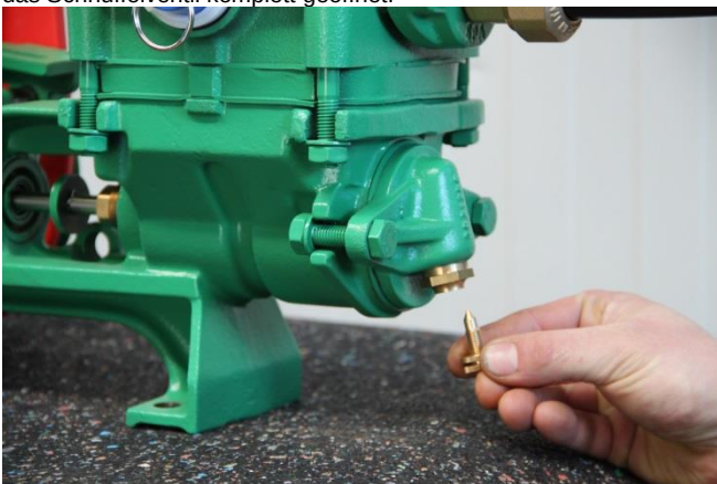
Hand-Schnüffelventil zur manuellen Belüftung öffnen
