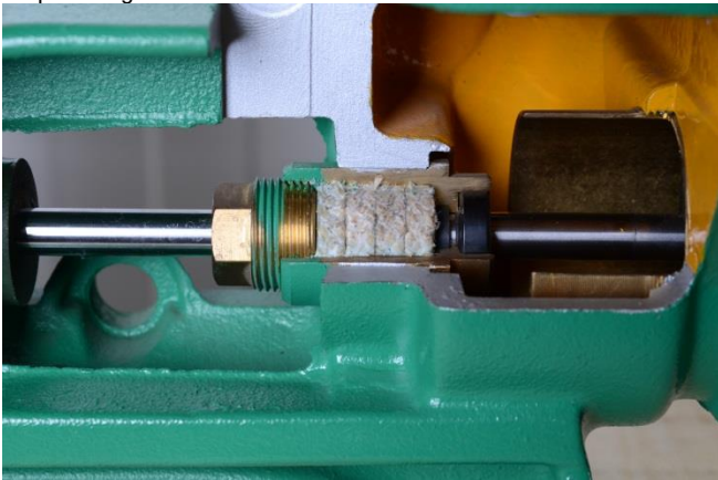
Stopfbuchsschraube – Packungsring - Wellendichtring
