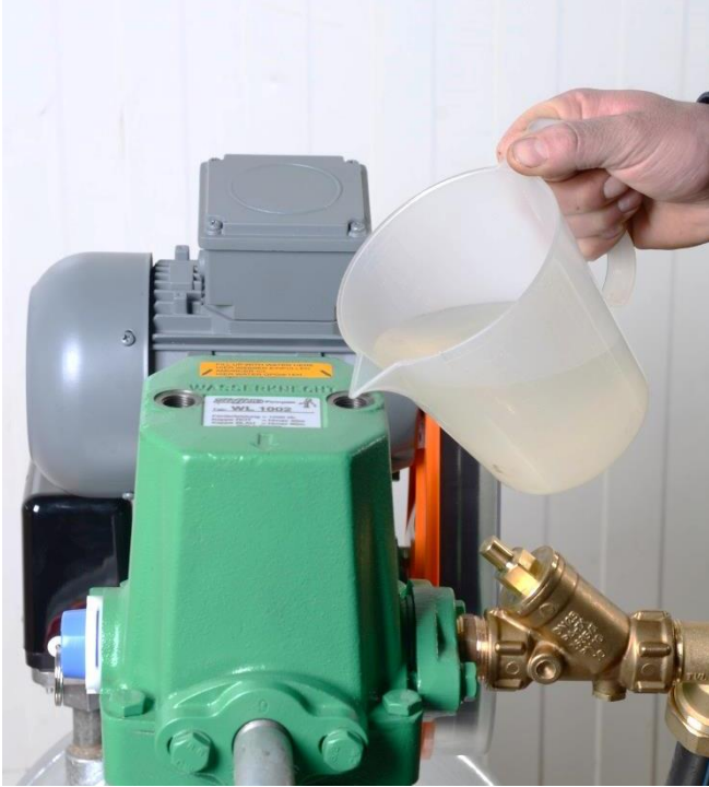
Wasser in den Druckwindkessel einfüllen
