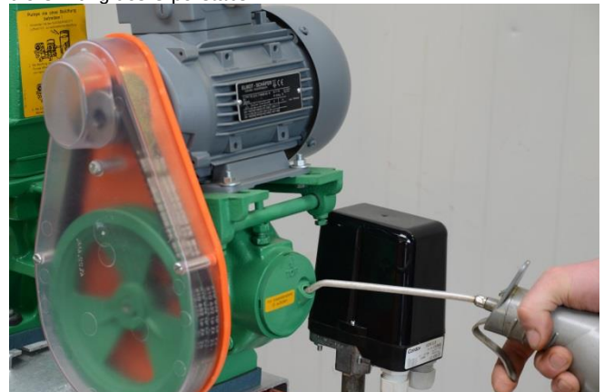
Vor Inbetriebnahme Öl auffüllen und mit Peilstab kontrollieren
