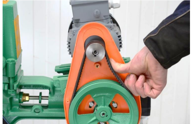
Die Keilriemen müssen sich ca. 1cm eindrücken lassen
