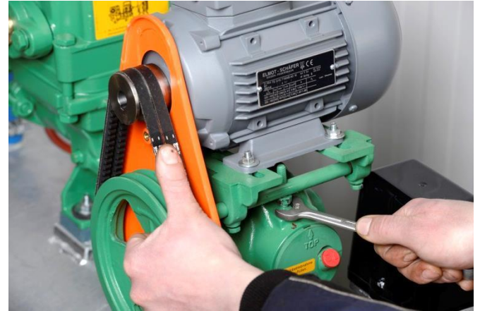
Riemenspannung mit Stellschraube einstellen
