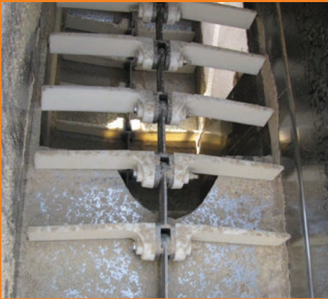
Futtermittel-Anwendung mit Bolt ,N' Go-Kette und Nylon-Mitnehmern
