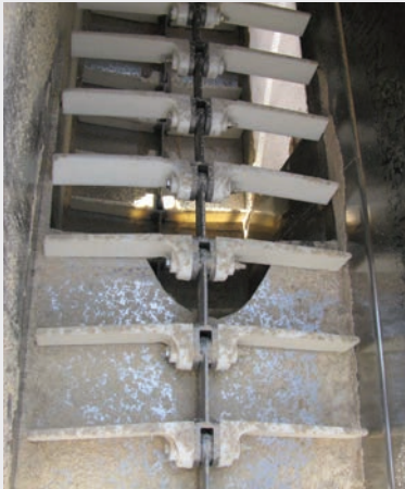
Futtermittel-Anwendung mit Bolt ,N' Go-Kette mit Nylon-Mitnehmern
