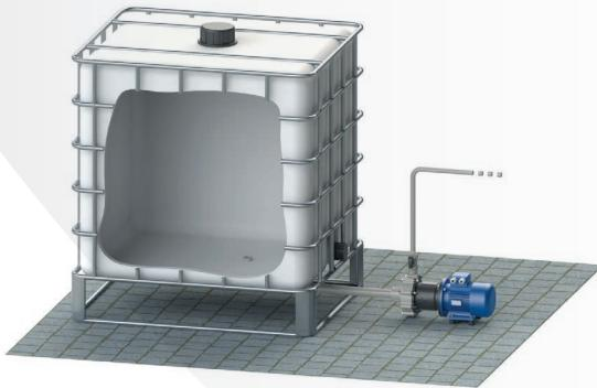
► **Installation - Positive Ansaugung:** Die Kreiselpumpen sollten nur mit horizontal positionierter Welle in einer positiven Ansauganordnung installiert werden. Zur Vermeidung von Trockenlauf, Wirbelbildung und möglicher Luftansaugung sind geeignete Vorrichtungen anzubringen. Trockenlauf oder Luftblasen können zu Schäden an der Gleitringdichtung führen.
