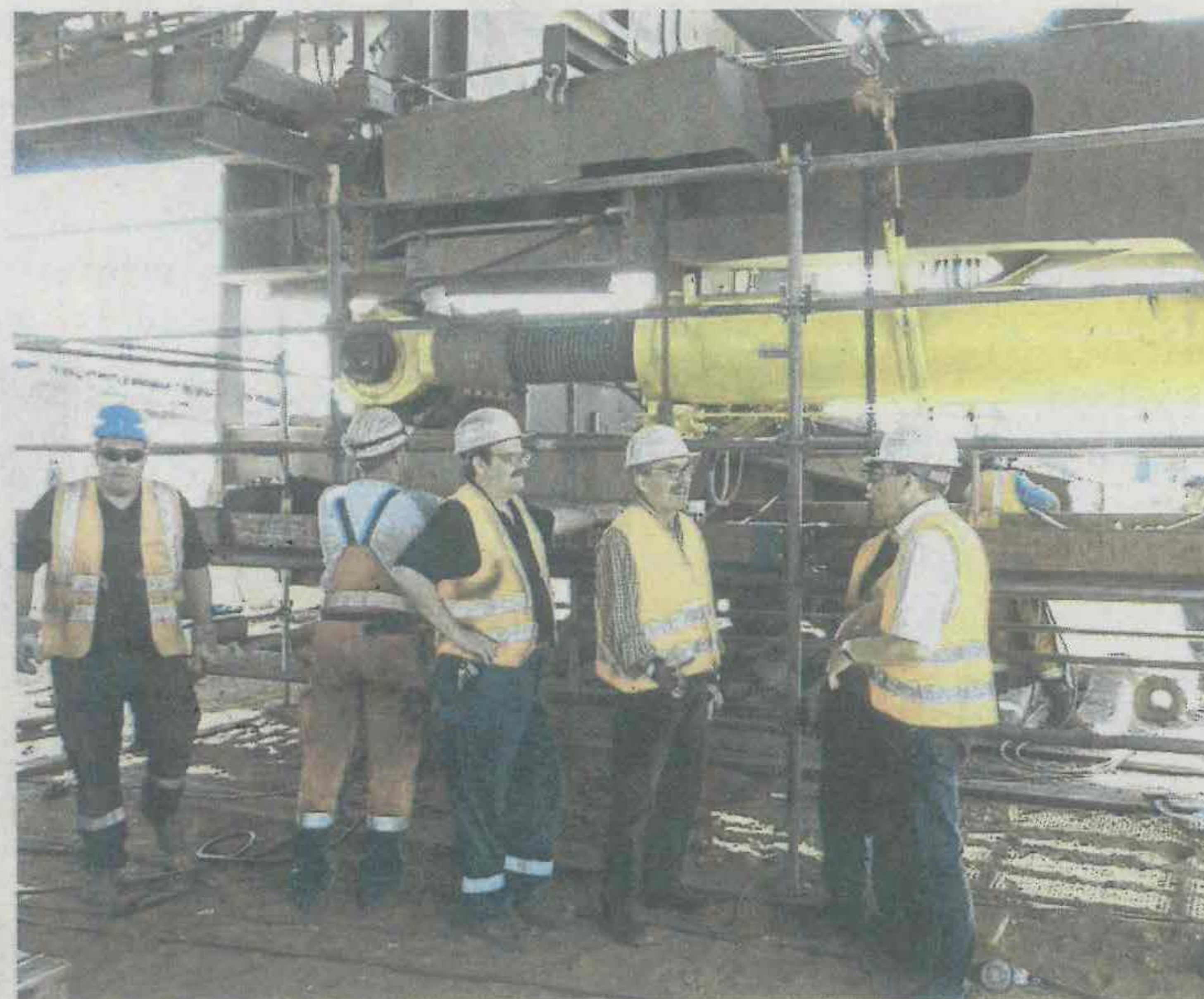
Vier Meter lang ist der gelbe Hydraulikzylinder, mit dem die Kette eines Bandschleifenwagens im Tagebau Hambach gelenkt wird.
