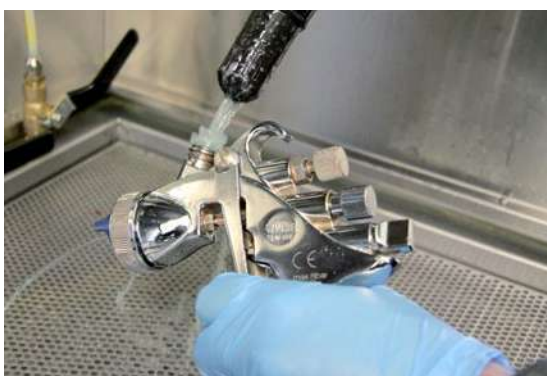
Reinigen von Lackierpistolen und -Zubehör im PROLAQ Auto
