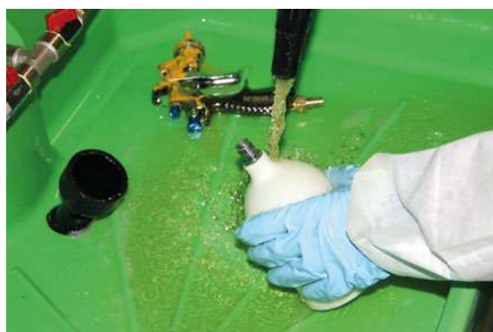
Reinigen von Lackierpistolen und -Zubehör im PROLAQ Compact
