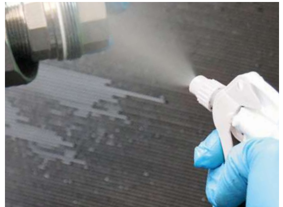
GS 200 aufspritzen – Dichtungsmasse entfernen
