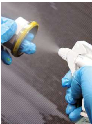
Dichtungsmasse entfernen mit GS 200
