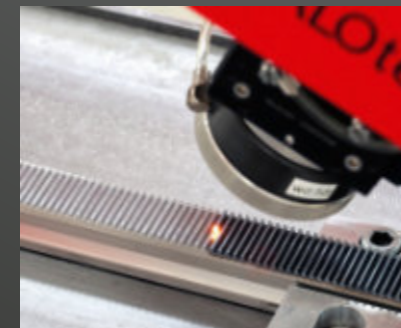
Laserhärten ALOhard zoom einer Zahnstange
