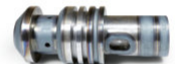
Lasergehärtetes Drehteil mit Oberflächenhärte 60 HRC
