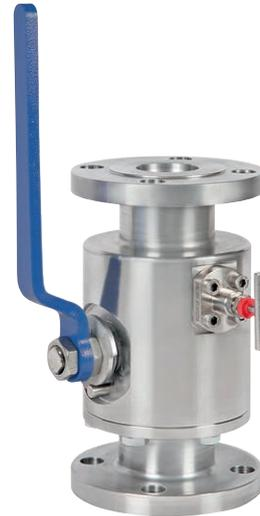
Das Ventilsitzdesign des Ventilgehäuses garantiert eine lange Lebensdauer und hohe Dichtigkeit. Dieses Ventil erfüllt die Anforderungen hinsichtlich flüchtiger Emissionen nach ISO 15848-1, Dichtheitsklasse B, und wurde nach API 607 auf Feuersicherheit bauartgeprüft.
