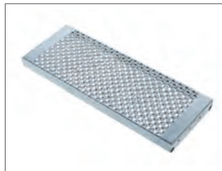
Stahl-Lochblech mit Rutschhemmungsklasse R13
