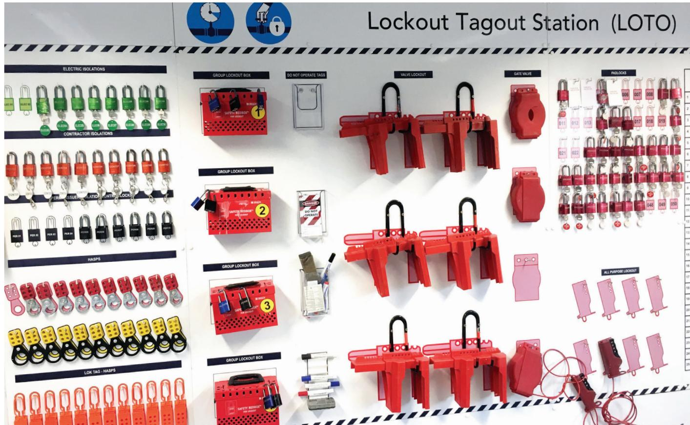
Mithilfe von gut sichtbaren, individuell anpassbaren Lockout-Shadowboards können Sie die Sicherheit am Arbeitsplatz in den Blickpunkt rücken und für eine höhere Lockout/Tagout-Effizienz sorgen.
