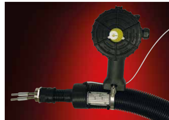
Spezial Analyseheizschlauch Typ ELH/2adsbw-100 °C- NW6/8-EX-SP für den Ex-Bereich mit 2 Innenseelen aus Fluorpolymer NW 6/8 und angebautem Ex-Klemmkasten; Typ-Ex-it-R. Haltetemperatur: 100 °C
