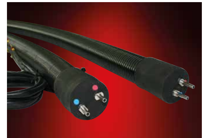
ELH/2aw-200 °C-NW6, Analyseheizschlauch mit 2 Innenseelen NW 6/8 aus Fluorpolymer & beidseitigem übergangslosem Spezial-RSL-Rohrstutzen. Haltetemperatur 200 °C
