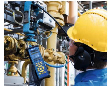
**Druckluft-Leckagen sind in der Regel unsichtbar und gerade bei laufender Produktion nicht hörbar.**
