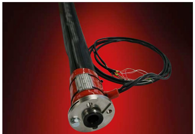
ELH/mdsb-80 °C-NW25-EX Heizschlauch für den EX- Bereich mit Fluorpolymer ausgekleide- tem Spezial-Flansch Anwendung: Abfüllschlauch in der Pharmaindustrie
