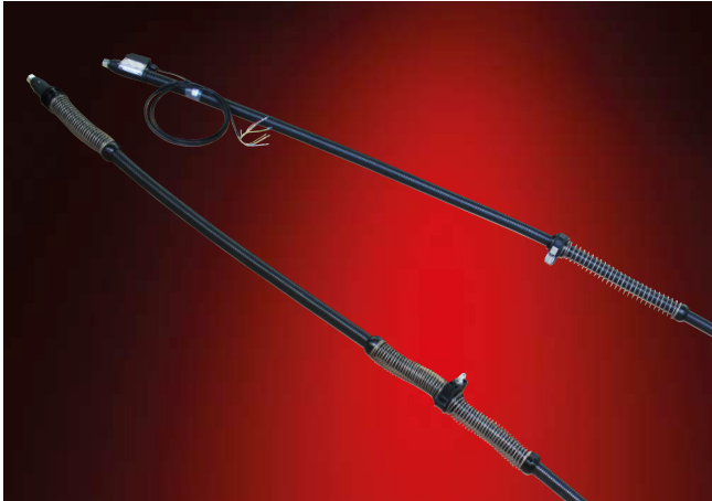
ELH/shdw-200 °C-DN10 Beheizter Hochdruckschlauch mit Knickschutzfedern, Aufhängevorrichtungen und Roboteräußenmantel Anwendung: Einsatz am Roboter für eine Extruderanlage
