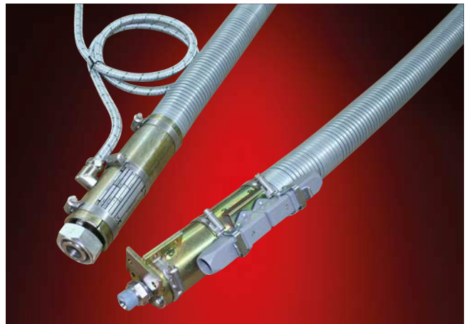
ELH-hdT 200 °C, NW 16 beheizter Druckschlauch in trittfester Ausführung mit Metallwellschlauch als Außenmantel, zusätzlicher Beileitung und Spezialendkappe; Anwendung: Bitumentchnik
