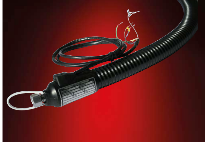
ELH/mdw-200 °C-DN10 Beheizter Druckschlauch mit Heizkabelüberstand zum beheizen der Anschlussarmatur; Anwendung: Anlagenbau / Transport von Öl und Fett für eine Beschichtungsanlage
