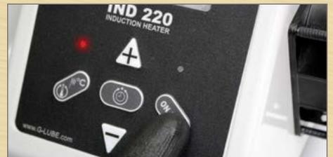
Die Anwendung von IND 220 ist denkbar einfach. In wenigen Schritten kann ein 5 kg schweres Lager in unter 3 Minuten auf 110 °C erwärmt werden!
