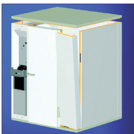
Het hoekpaneel tegenover de koelunit aan de voorzijde wordt als laatste geplaatst van de zijwanden. Nadien worden de plafondpanelen als laatste stap gemonteerd.
